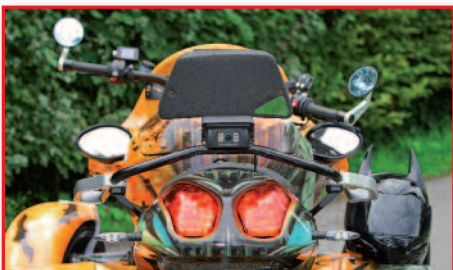
Rücksicht: Lenkerend-Spiegel & Rückfahr-Kamera
