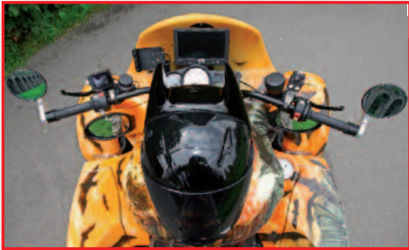
Cockpit: mit Shifter-Schaltung & Servolenkung
